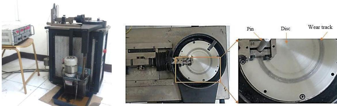
**Fig. 4 Pin-on-disk tribometer**
